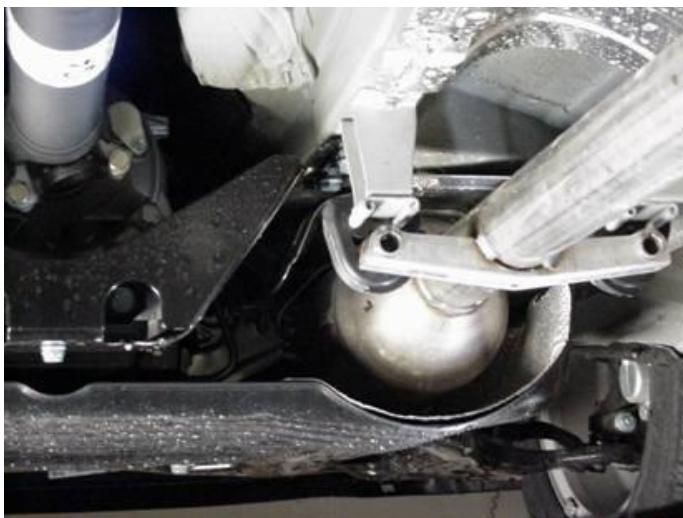
Filtro de partículas instalado en los bajos del vehículo y posterior al catalizador de oxidación
