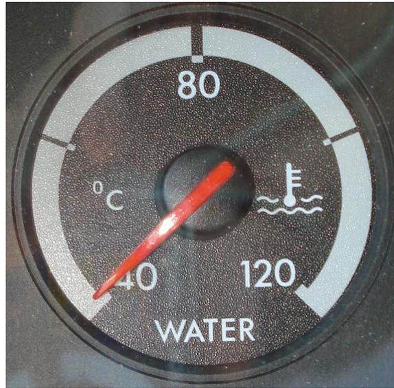
Durante la operación normal del motor, el medidor de temperatura del líquido refrigerante debe tener lecturas entre 175 y 195\_F (80 y 95\_C). Si la temperatura permanece debajo de los 160\_F (71\_C) o excede la temperatura máxima mostrada en la siguiente tabla, inspeccione el sistema de enfriamiento para determinar la causa. Vea el manual de taller del vehículo para procedimientos de localización de averías y de reparación.
