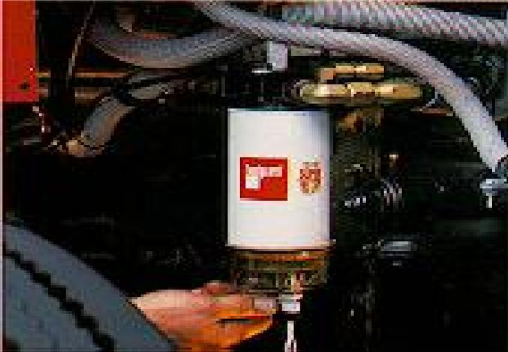
**ADVERTENCIA: TENER UN FILTRO DE COMBUSTIBLE EQUIPADO CON SENSOR DE AGUA EN EL COMBUSTIBLE NO SE LIBERA DE LA RESPONSABILIDAD DE INSPECCIONAR Y PURGAR A DIARIO.**
