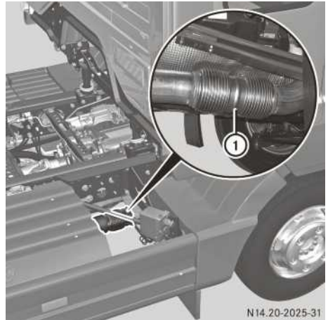
Elemento de desacoplamiento entre el motor y el tubo de escape
