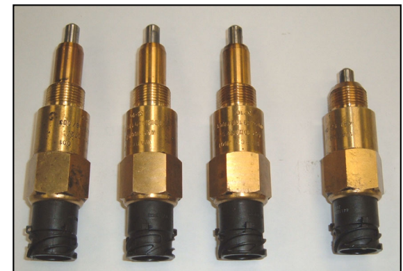
Fotos de los sensores de recorrido montados en la caja de cambios (Telligent GS2)
