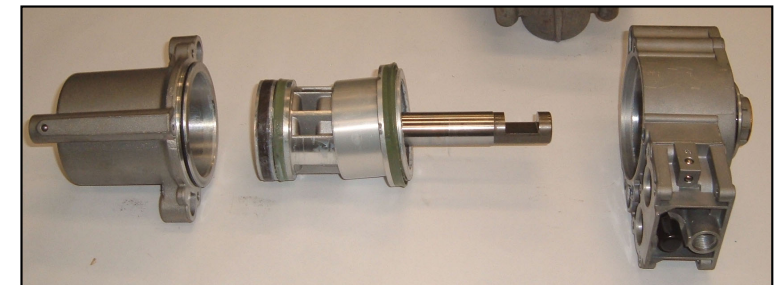
Detalles de los componentes de cilindro de accionamiento neumático de la unidad de acoplamiento
