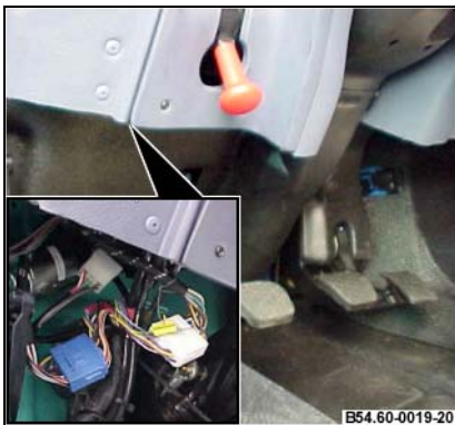
Conectores debajo del tablero
