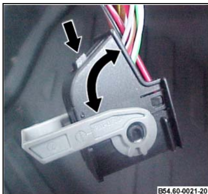
Bloqueo de los conectores del módulo "UCV"
