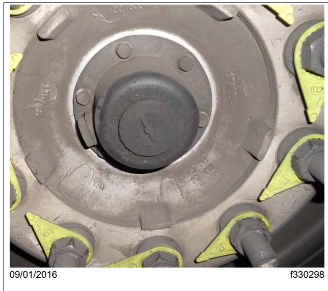
Figura 8, Ventilación de aceite normal
