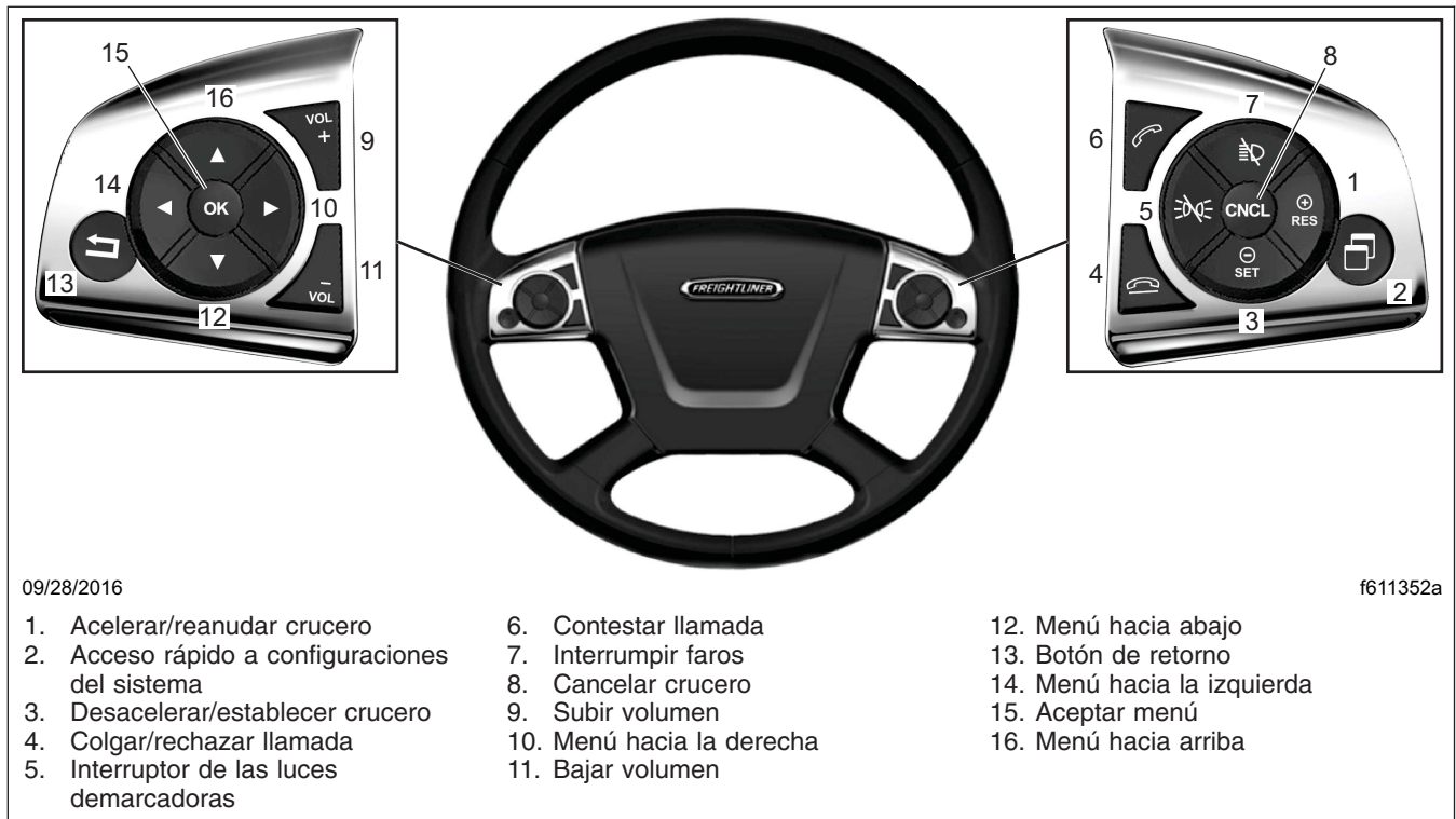
Figura 3.13, Interruptores montados en el volante
