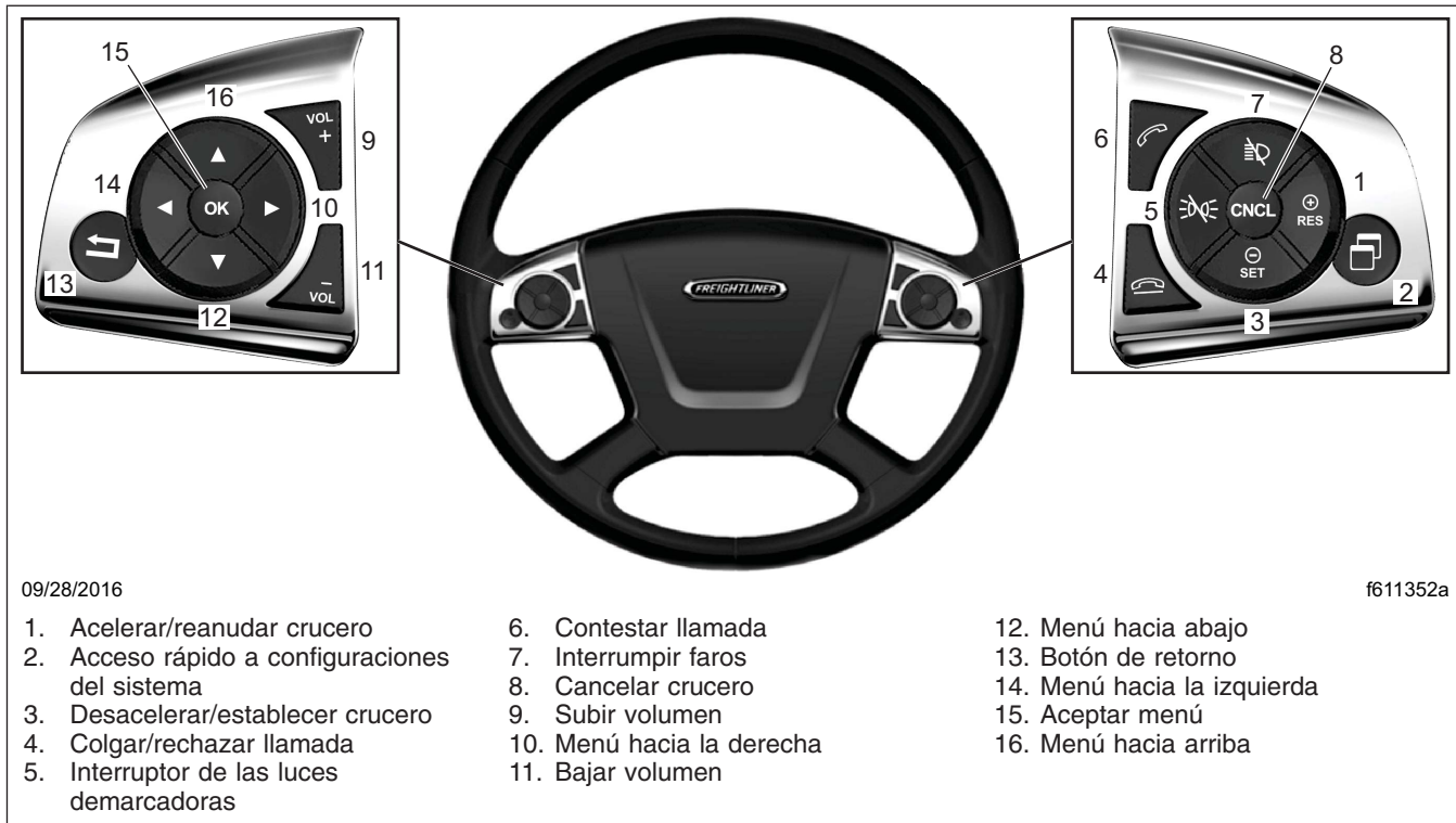
Figura 4.17, Interruptores montados en el volante
