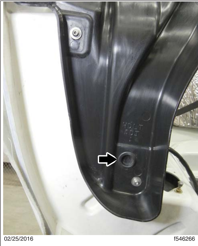
Figura 20.4, Ajuste del faro (se muestra con el capó abierto)
