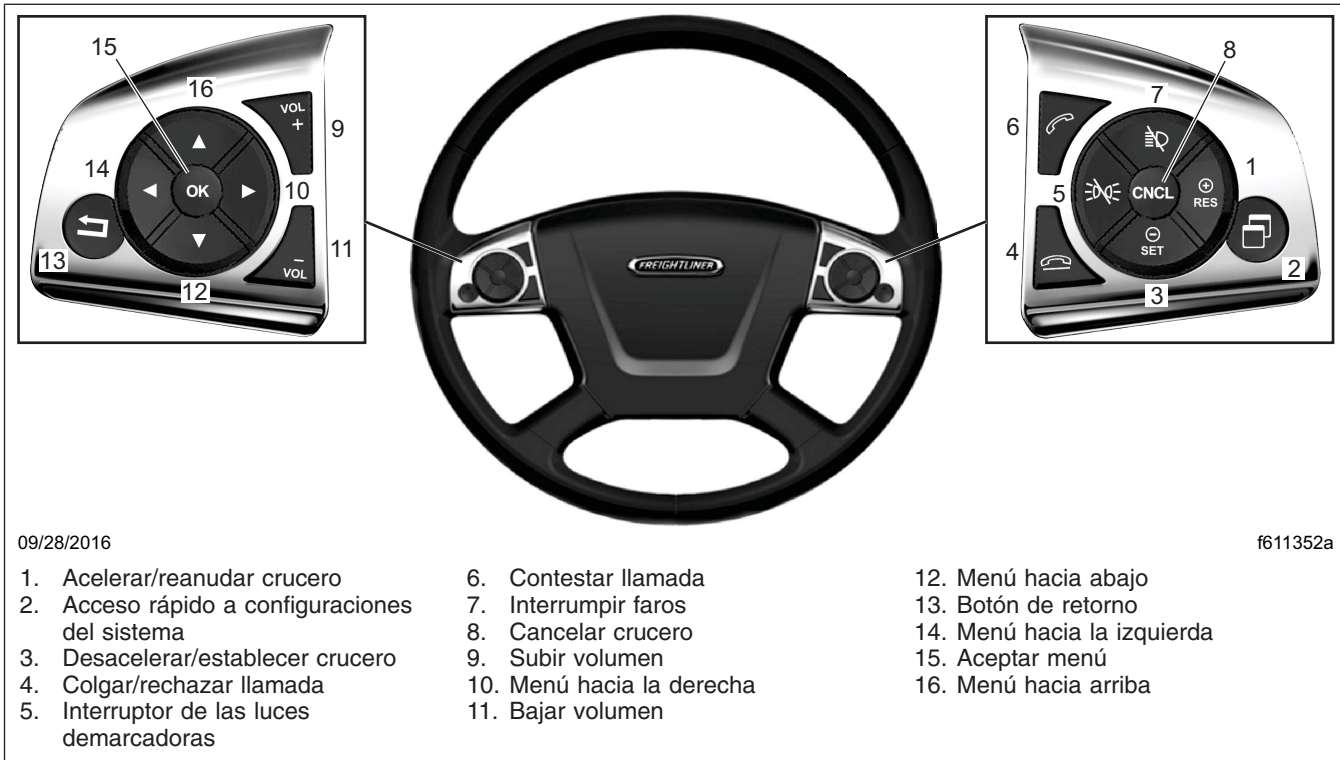
Figura 4.6, Interruptores montados en el volante
