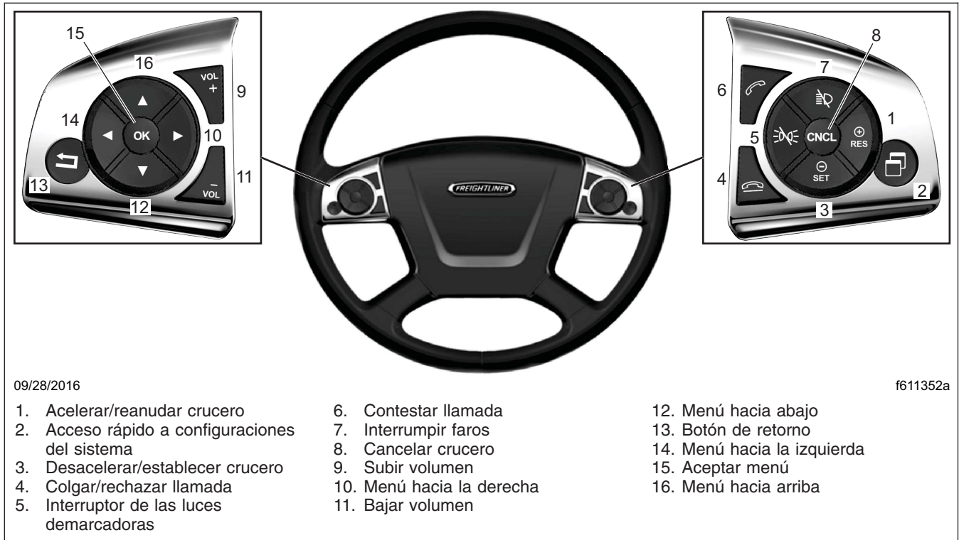
Figura 5.1, Interruptores montados en el volante
