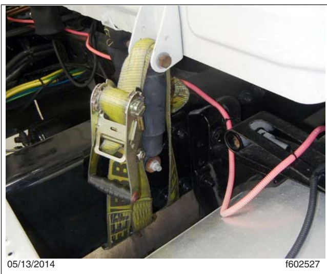
Figura 24.4, Correa de tensión instalada para anclar la cabina
