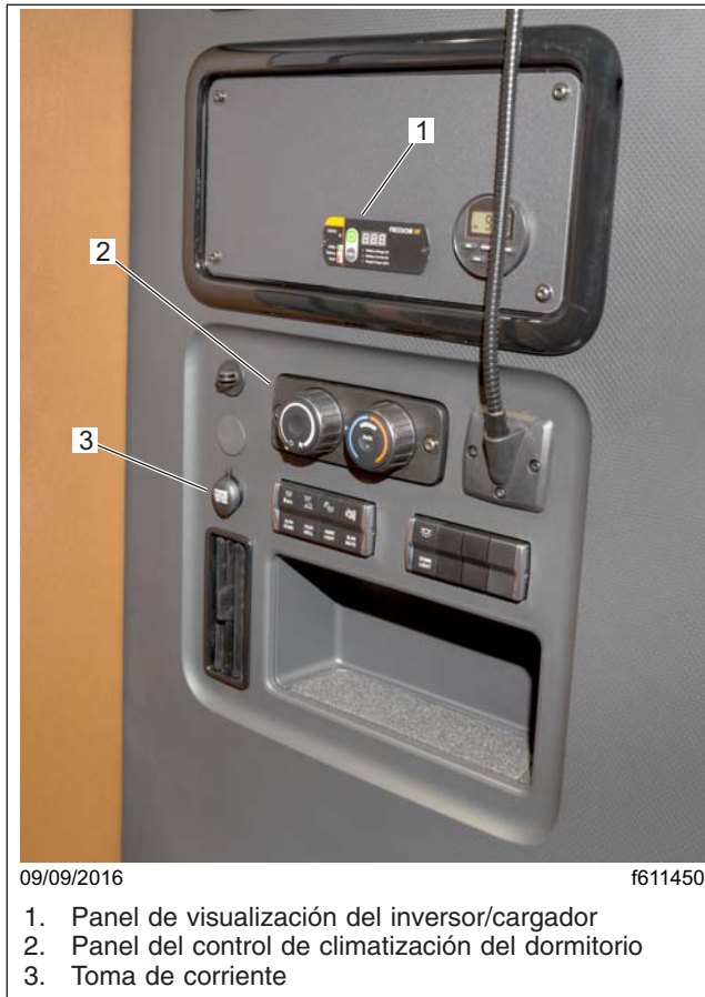
Figura 8.4, Panel de control del dormitorio
