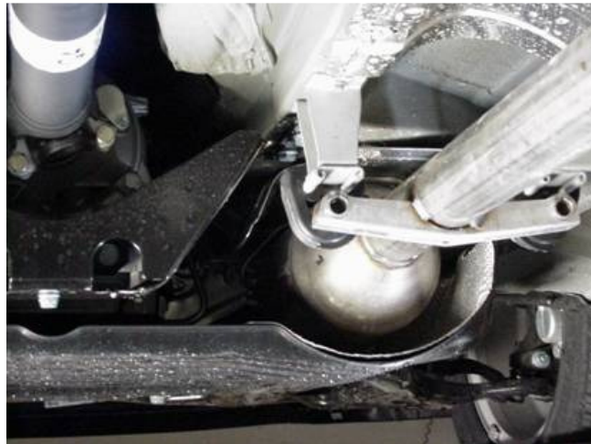
Filtro de partículas instalado en los bajos del vehículo y posterior al catalizador de oxidación
