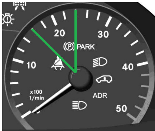
Máximo torque del motor OM 651 LA (1200 - 2400 RPM) código MR3 Sprinter 311
