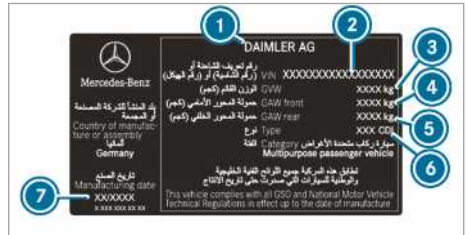
Placa de características del vehículo (ejemplo: Estados del Golfo)
