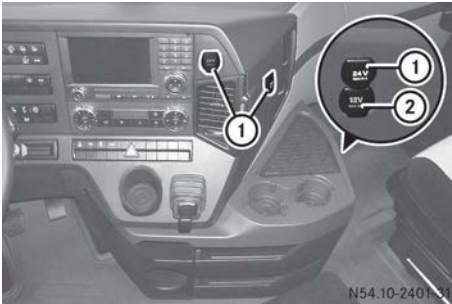
Tomas de corriente situadas en el puesto de conducción (ejemplo)
