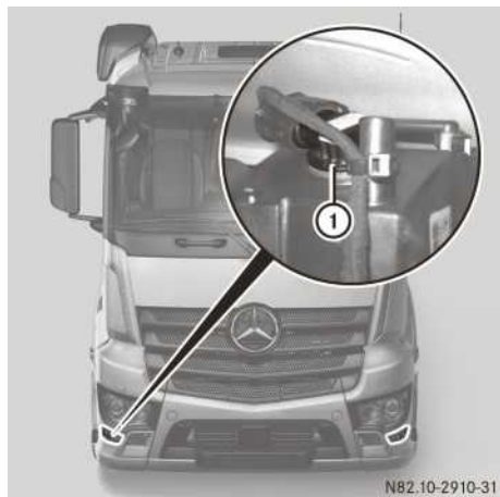
Faro antiniebla (ejemplo de un faro antiniebla con luz diurna LED del Antos)
