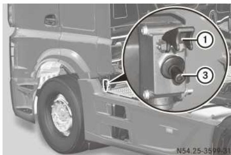
Seccionador de la batería (ejemplo)
